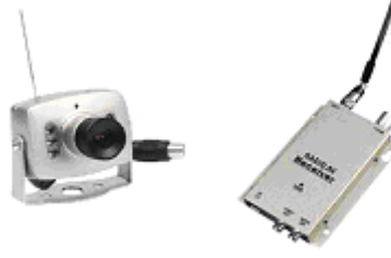
Őekil 7. RF sinyalleri ile iletiŐim kurulan g¼venlik kamerası.
