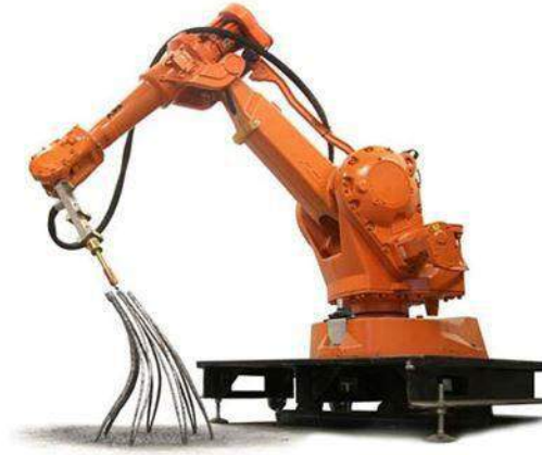
Şekil 1.4 Metal baskı yapan endüstriyel robot.
