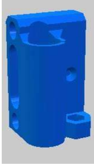
Şekil 37 Z eksenini hareketi sağlayan parça
