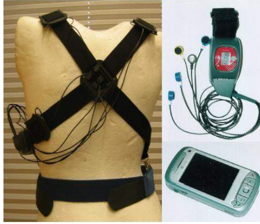
Şekil 2.16. Myofeedback BAN: Giysi, Elektrotlar, ReTra ve MBU
