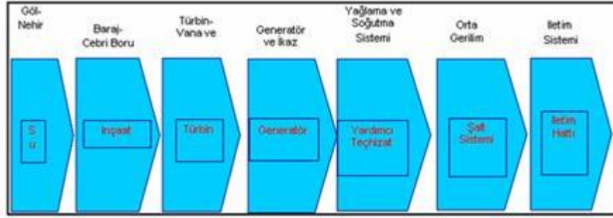
Şekil 4: Hidroelektrik Santrali Akış Şeması
