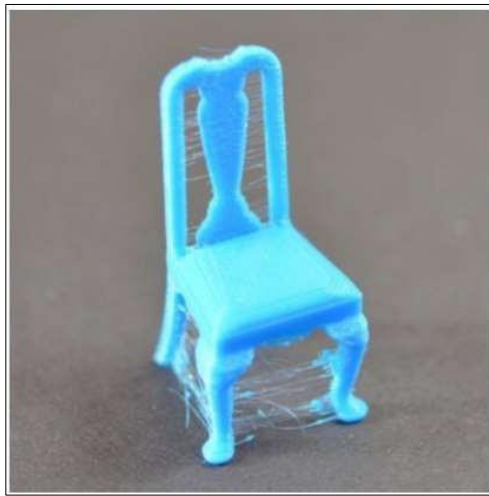
Şekil 2.5. İmalat hatası saçaklanma.
