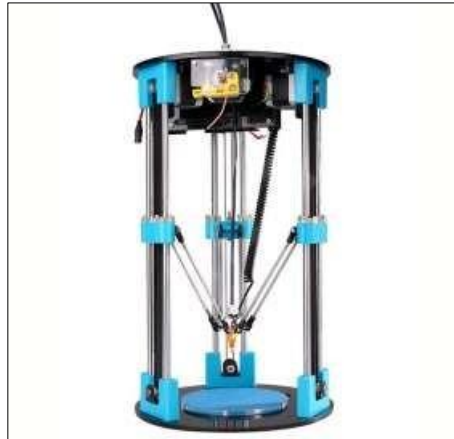
Şekil 1.2. Delta robot tipi üç boyutlu yazıcı.
