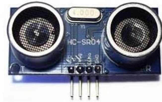
Şekil 13. HC-SR04 Ultrasonik Mesafe Sensörü
