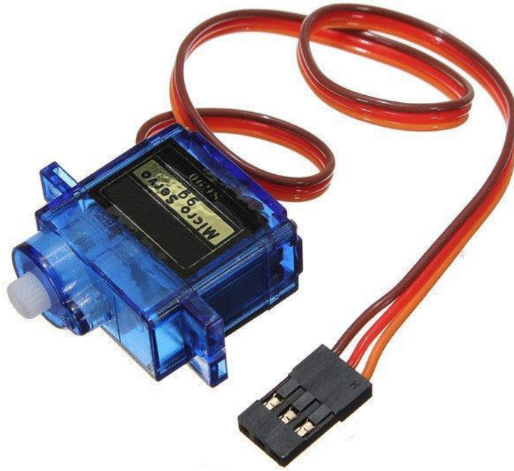
Şekil 8. SG90 9G Servo Motor
