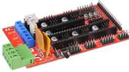
Şekil 4.2 RepRap v1.4 Kontrol Kartı
