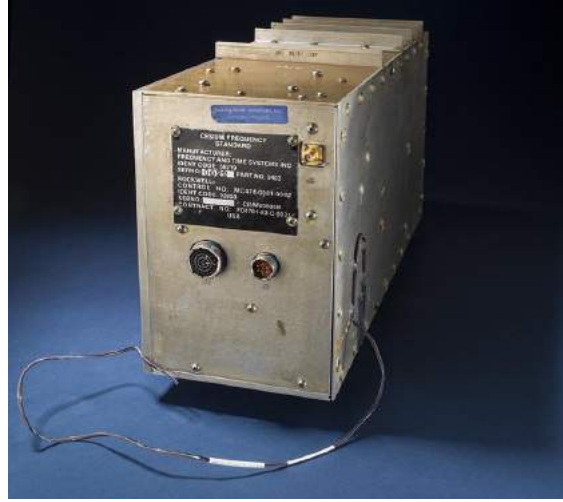
Şekil 10: Zamanı daha hassas ölçmek için kullanılan atomik saat modülü
