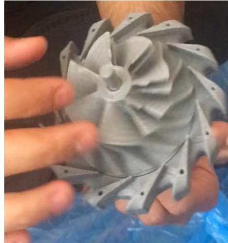
Şekil 5.1 – 5.2 Turbojet Motoru Bileşenlerinin 3d Pinter Ile Çıktıları
