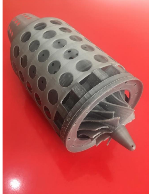
Şekil 5.4-5.5 Turbojet Motoru Bileşenlerinin 3D Çıktılarının Montajlanmış Son Hali
