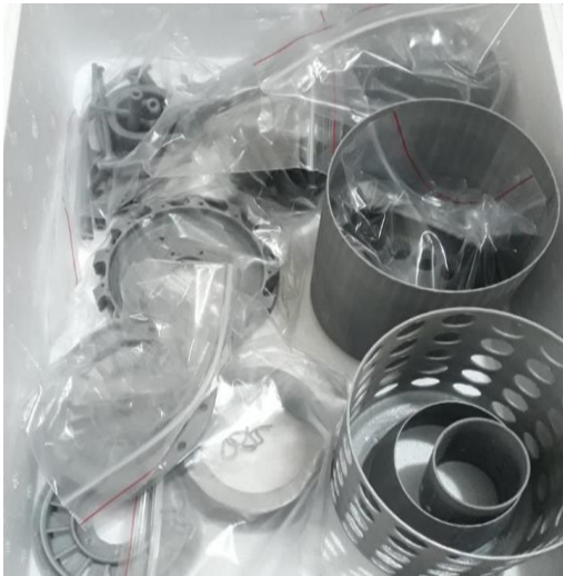
Şekil 5.1 – 5.2 Turbojet Motoru Bileşenlerinin 3d Pinter Ile Çıktıları
