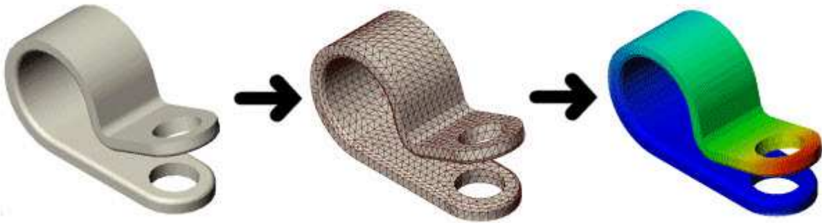
Şekil. Geometrik model, Sonlu eleman modeli ve sonuçların gösterildiği nodal sonuçlar.
