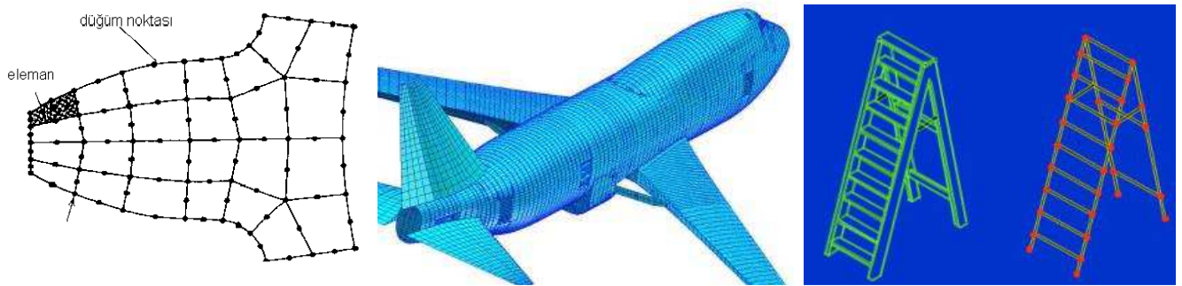
Şekil. Çeşitli mesh tipi örnekleri. a) Bir dişlinin iki boyutlu olarak mesh yapılmış şekli, bir uçağın üç boyutlu mesh yapılmış şekli. b) İçi dolu katı modelde kullanılabilir, kabuk modelde kullanılabilir. c) bir merdivenin 1 boyutlu çizgi elemanlar ile modellenmesi.
