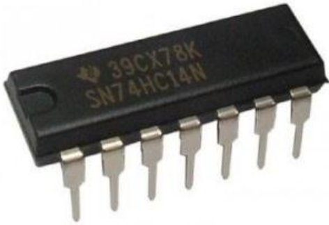
Şekil10. 74HC14 Entegre gösterimi
