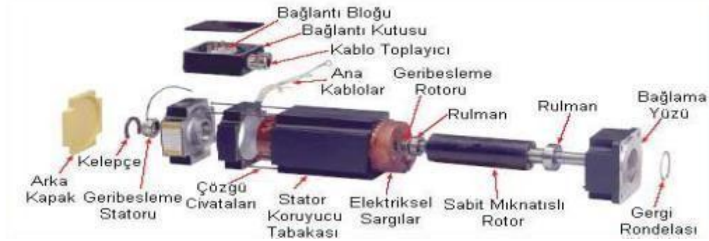
Şekil 3.7 Fırçasız bir Dc Motorun içyapısı
