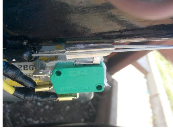
Resim 9: Fren sıkılı olduğunda butonun durumu
