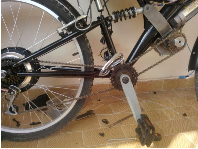
Resim 3 : Tahrik Motoru, Aktarma sistemi ve HUB Motor'un montajlı görüntüsü
