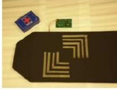
Şekil 3.29. Kablosuz EKG Sistemi
