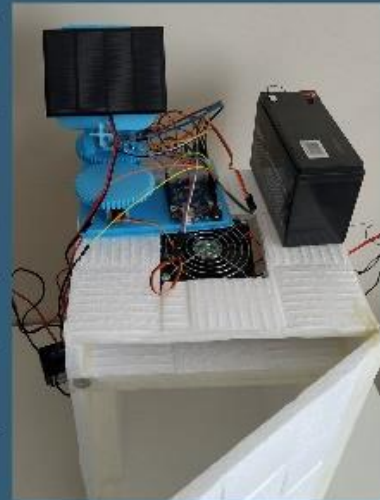
Şekil 4. Güneş paneli ve mini buzdolabı genleşme gazı kontrolü
