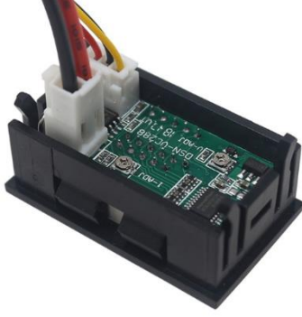
Şekil 2.17 Dijital Voltmetre İçi
