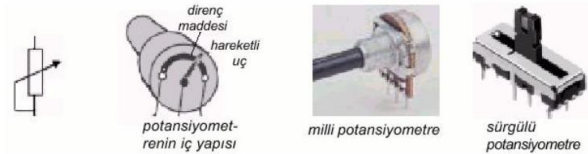
Şekil 2.43: Potansiyometre sembolü, potansiyometrenin iç yapısı ve potansiyometre
