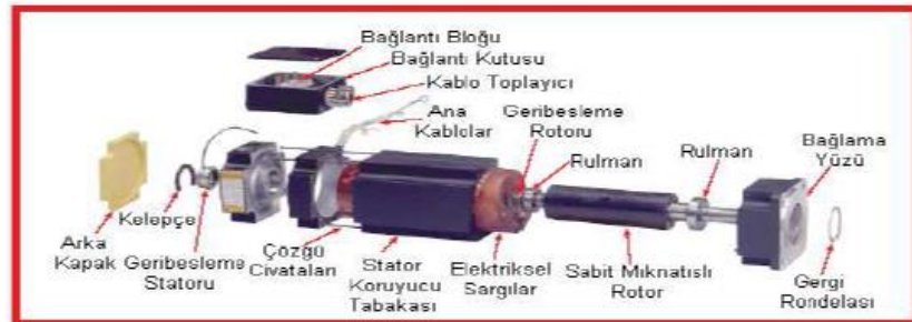
Şekil 1.33: Fırçasız bir DC motorun içyapısı
